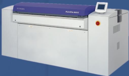
لیتوگرافی فرایندی است که ما طی آن صفحه هایی فلزی از جنس آلومینیوم موسوم به پلیت جهت چاپ آماده می‌کنیم. از این صفحه‌ها در چاپخانه برای استفاده در دستگاه چاپ افست برای انجام عملیات چاپ بر روی کاغذ استفاده می‌نماییم. در لیتوگرافی ابتدا فایل‌ها به چهار رنگ اصلی تقسیم می‌شوند و سپس تصویر مریبوط به هر رنگ بر روی صفحات پلیت طرح زنی می‌شود، و پس از ظهور و ثبوت آماده فرایند چاپ می‌شود.
